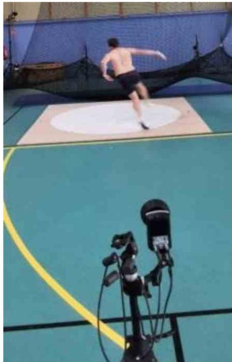
*Des caméras optiques détectent les capteurs réfléchissants positionnés sur Tom et son disque. Chaque point sur l'écran est un capteur, il y en a sur chaque articulation (points verts) et sur le disque (points bleus).*
