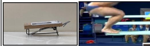
Pour déclencher le mécanisme, nous sollicitons son "interrupteur" (élément métallique sur lequel la souris doit marcher pour déclencher le piège) : l'articulation se déplie, résultant en un saut de la tapette et une déflexion de la planche.
