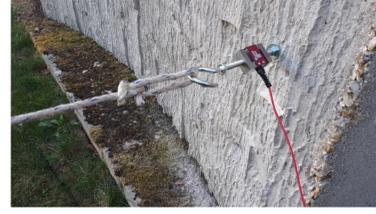
Protocole: Mesure de la force exercée en bout de corde à l'aide d'un capteur de force
